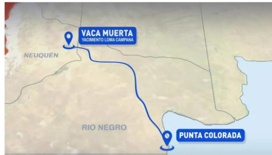
Recorrido del Oleoducto Vaca Muerta Sur, que atravesará unos 600 kilómetros desde la cuenca neuquina hasta el golfo San Matías, en Río Negro. Captura video YPF.
